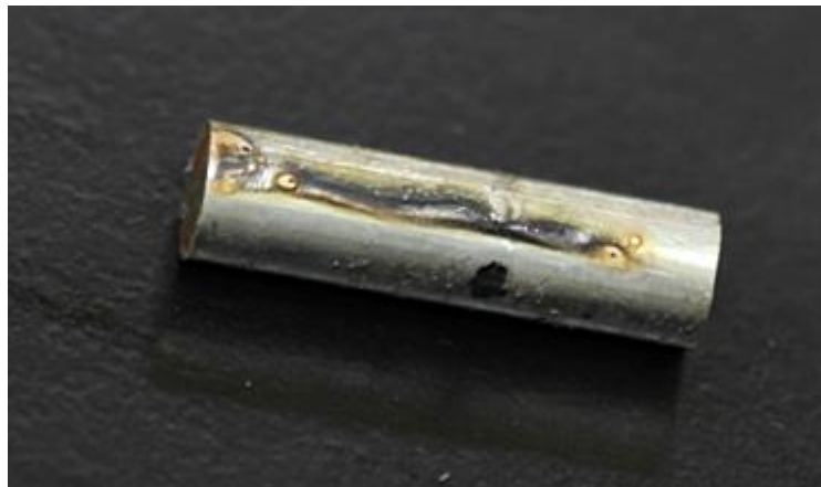
圖 3-9 不銹鋼圓棒試片浸漬試驗 (60°C, \text{Na}_2\text{S}_2\text{O}_3 + NaCl 溶液)
