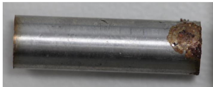
圖 3-10 不銹鋼圓棒試片濕潤試驗 (60°C, \text{Na}_2\text{S}_2\text{O}_3 + NaCl 溶液)
