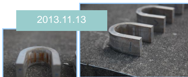
圖 3-13 U 形試片大氣曝露試驗
