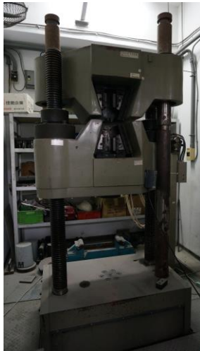
圖 3-12 試片規格與成品，拉升試驗機與鹽霧試驗機
