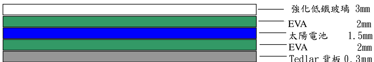
圖 11、太陽電池模組封裝疊層示意圖
