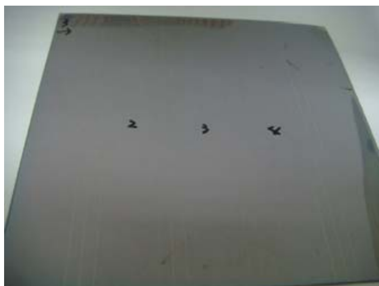
圖 7、a-Si 鍍層厚度為 200nm 試片
