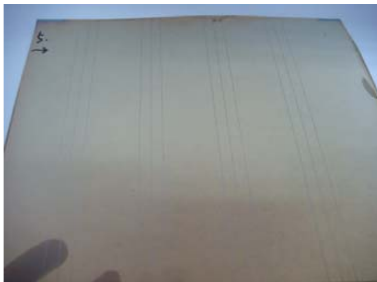
圖 6、a-Si 鍍層厚度為 300nm 試片
