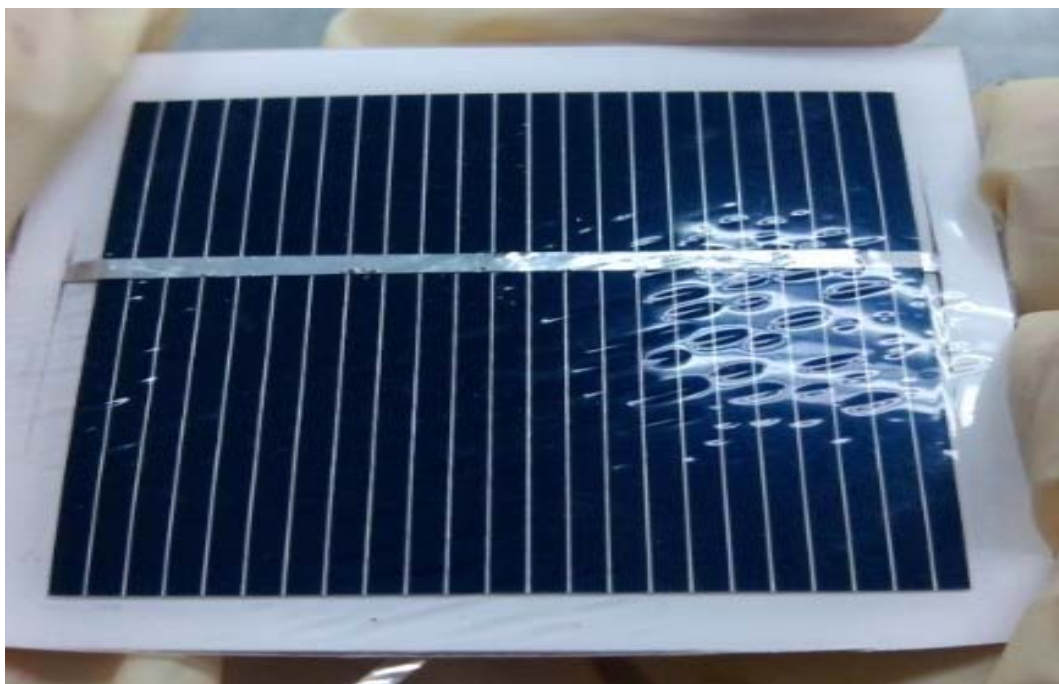
圖三十五 微透鏡直徑 100\mu\text{m} 之杜邦 ETFE 膜表面浪紋
