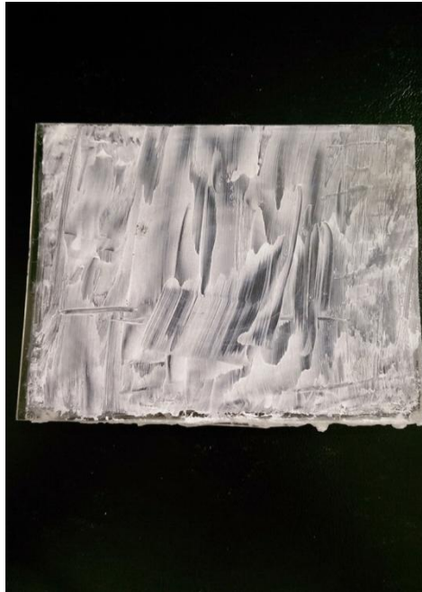
圖 2-6:二氧化鈦塗佈於 PMMA 透鏡之硬質膜
