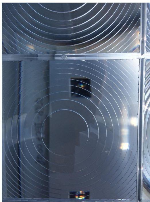
圖 1-3：聚光鏡面菲涅爾透鏡(Fresnel Lens)
