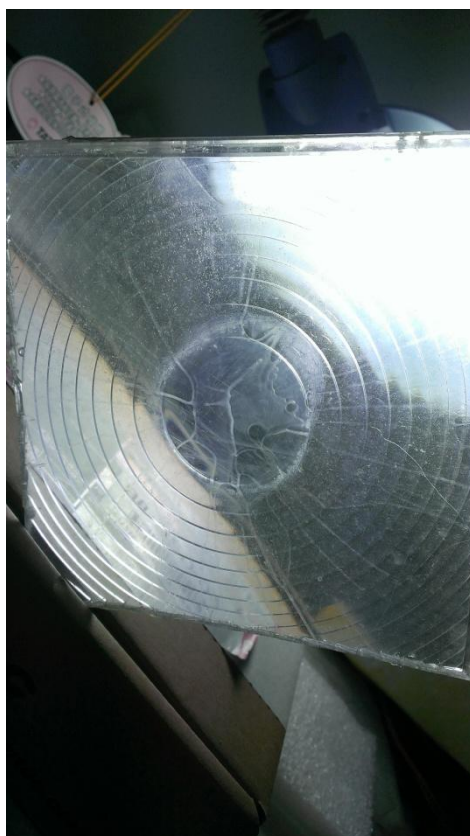
圖 3-15：硬質膜於 PMMA 透鏡經 2 個月戶外實測之鏡面圖
