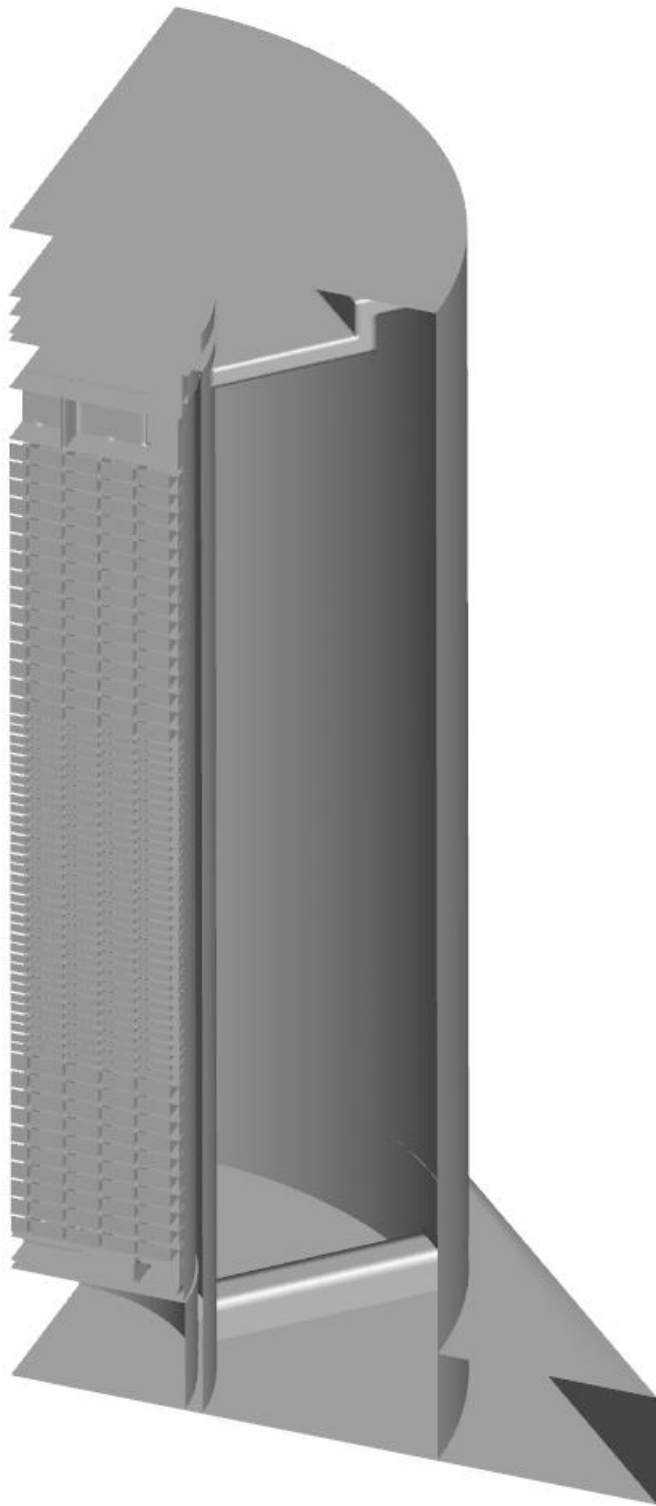
圖 9、核一乾貯系統幾何示意圖
