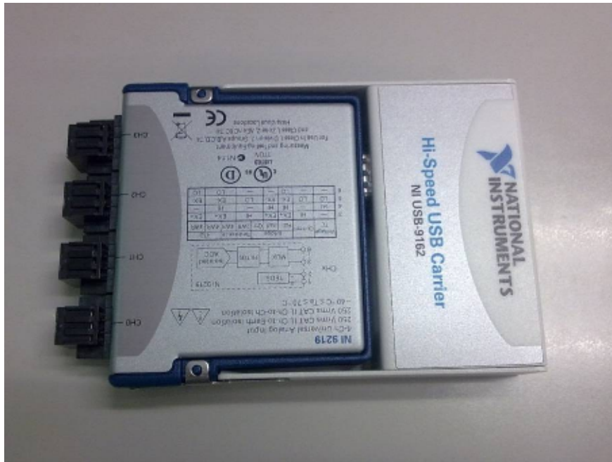
圖 2- 16 NI 公司的擷取卡，型號為 NI9219，每秒可擷取 7 個數據
