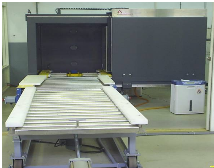
圖 7、Canberra/Q2 純鍺偵檢器組合量測系統
