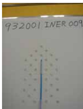
圖四：塑膠套管治療器線射源於空氣中測量情形。
