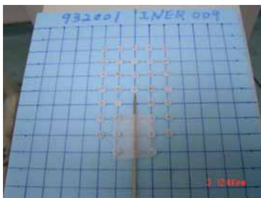
圖十七：攝護腺插種用不銹鋼治療器單一點射源水中劑量分佈測量情形
