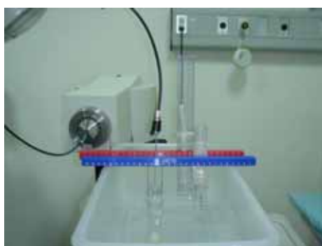
圖二十三：測量用之模擬空氣與水的不均勻假體。
