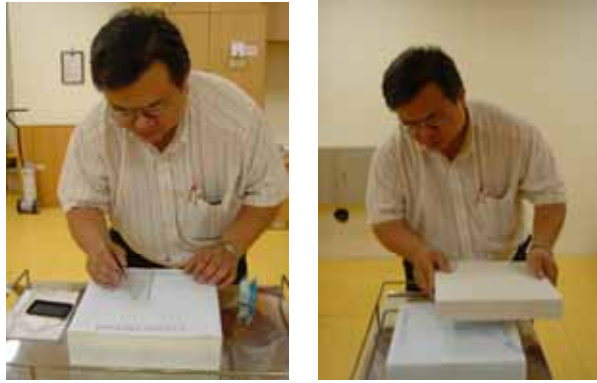
圖六：塑膠套管治療器線射源於固態水假體中測量情形
