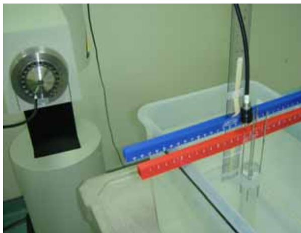
圖二十：四根線射源圍繞成圓狀模擬攝護腺插種治療時水假體中的劑量情形。
