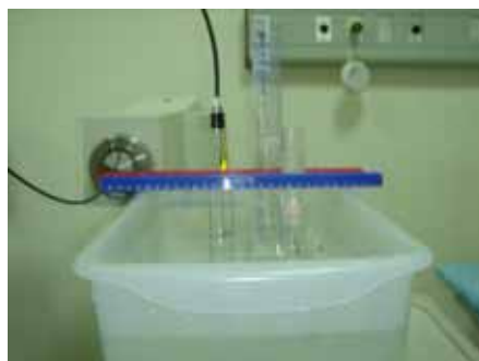
圖二十四：單一點射源安置於不均勻假體內的空氣中，量測在不均勻物質時的劑量分佈測量情形。
