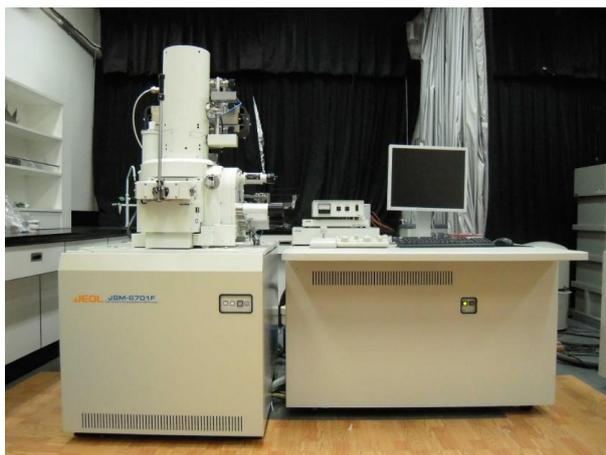
圖 4. 冷場發射掃描式電子顯微鏡
