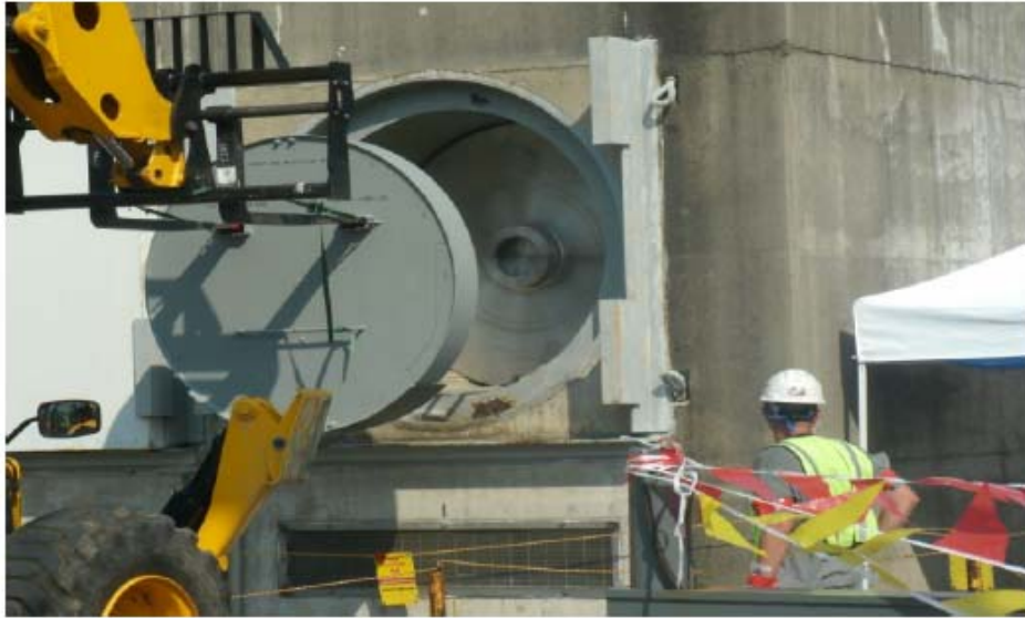
圖 4.1.6 CISCC 研究用密封鋼筒模型
