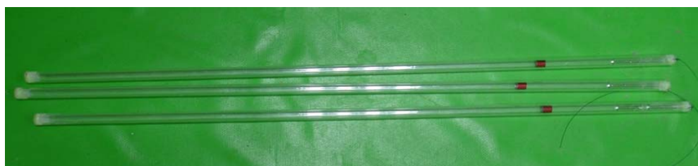
圖 4：核種 ^{241}\text{Am} 液態棒狀射源
