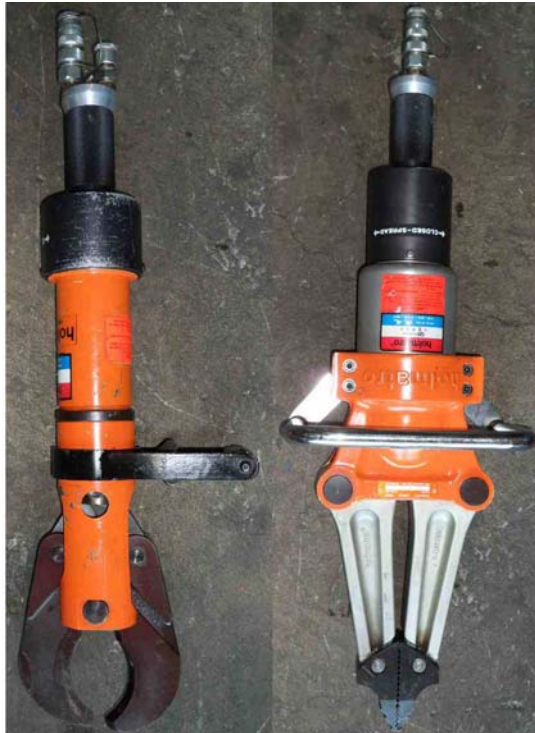
圖 3-15 (左) 油壓剪 (右) 油壓撐開器
