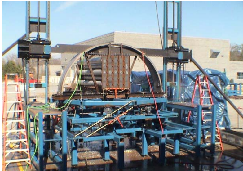
圖 4-23 往復式工具機實物模型測試
