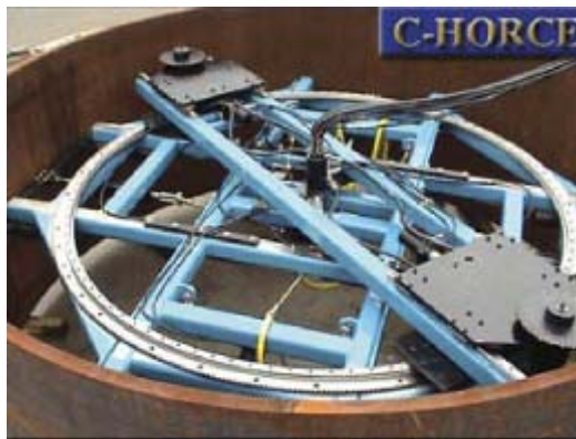
圖 4-21 環形液壓操作切割設備(CHORCE)概念圖
