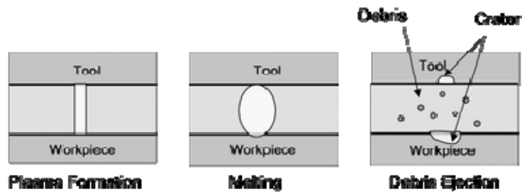
圖 3-8 放電加工去除材料示意圖
