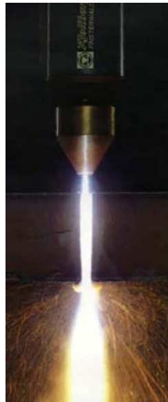
圖 3-5 電漿火炬切割鋼板
