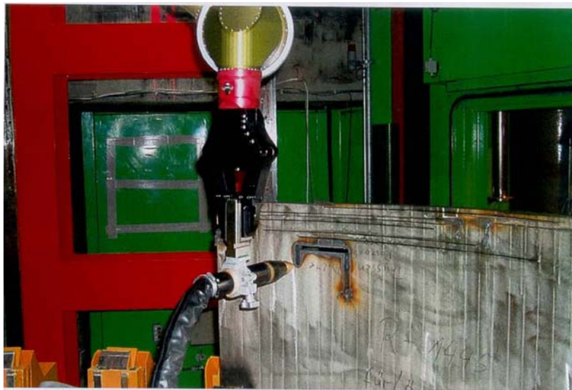
圖 3-26 機械手攜帶電漿火炬切割鋼板
