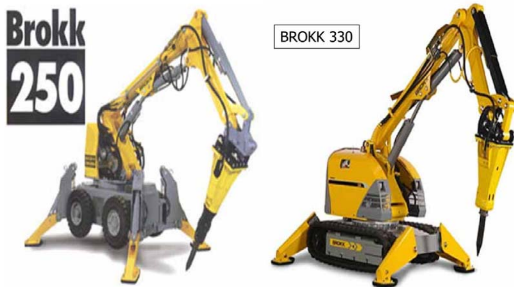
圖 3-25 遙控的反鏟式衝擊錘
