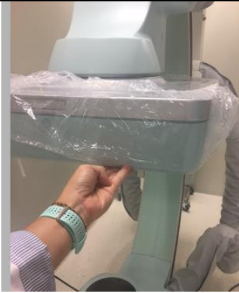
圖 2：輕推 X 光管感應器，儀器應立即停止移動。
