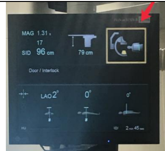
圖 5：當有碰撞到影像增感屏碰撞感應器時，設備螢幕會顯示警告狀態(紅色箭頭)。解除碰撞開關後設備才可以正常運作。
