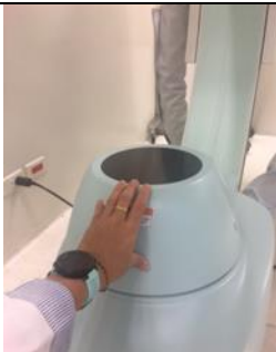
圖 4：輕推影像增感屏碰撞感應器，儀器應立即停止移動。
