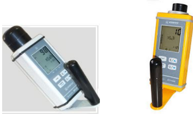
圖 3.1 手持式塑膠閃爍偵檢器 ATOMTEX AT1121(AT1123)(左)、 NaI(Tl)閃爍偵檢器 AT1103M(右)。
