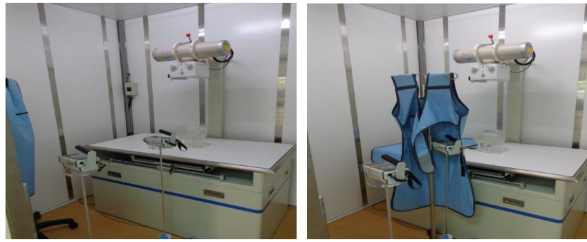
圖 3.2 考量動物用 X 光機協助者在檢查室內協助動物擺位照相的情形，以手持式偵檢器測量，評估其有穿(右)及無穿(左)鉛屏蔽衣之居佔位置劑量(率)示意圖
