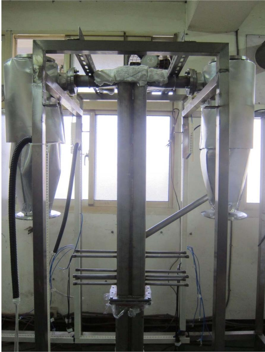
圖 3.4 20 kWth 內通式流體化床氣化熱模系統內部體化床氣化爐管實體圖
