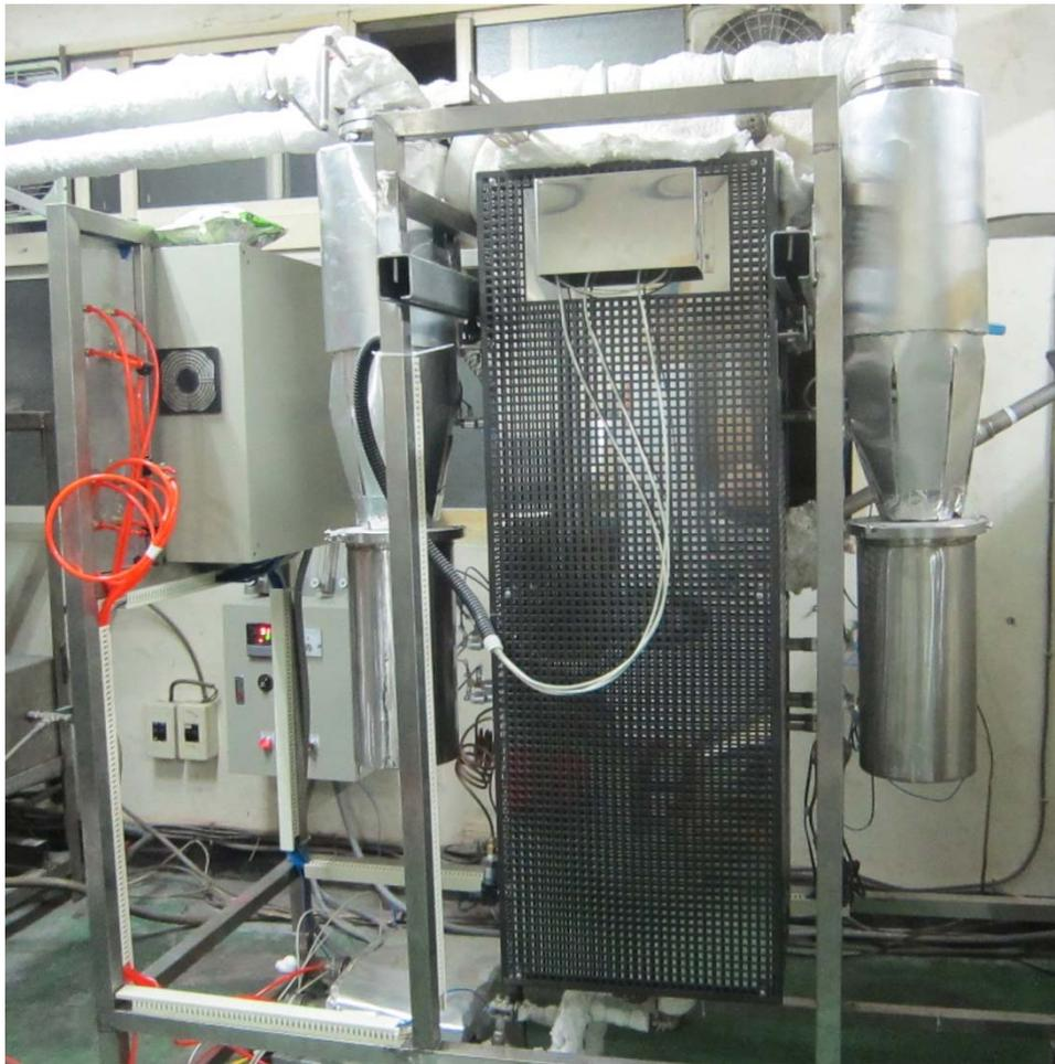
圖 3.3 20 kWth 內通式流體化床氣化熱模系統整體外觀圖
