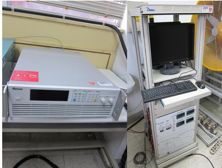
圖 19. 可程控直流電源供應器與系統實體圖
