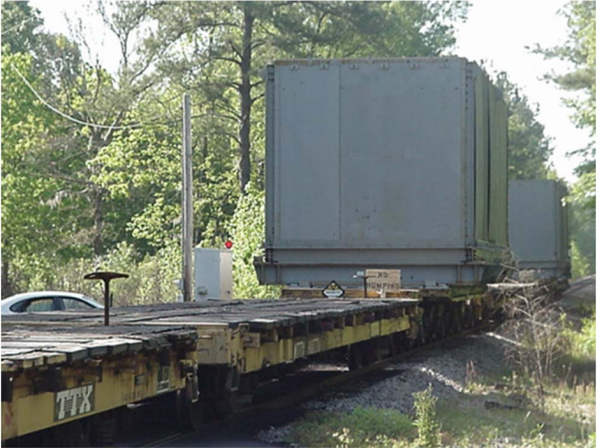
圖 4-7 鐵路運輸蒸汽產生器下端組件從南卡羅來納州海岸至 Barnwell
