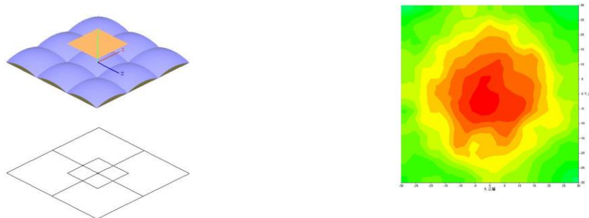
圖十一 (a)模擬的透鏡陣列 (b)在焦平面上的光分佈
