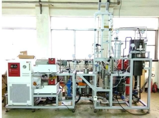
圖 5、試驗型 2L 萃取設備
