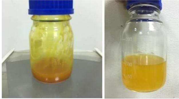
圖 21、無破菌濕菌(輔溶劑)脂肪酸萃取物：(左)第一段、(右)第二段
