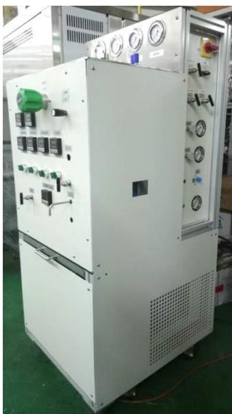
圖 1、實驗型超臨界二氧化碳萃取設備
