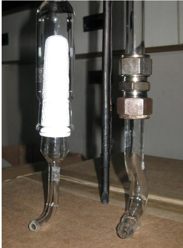
圖 2-8 焦油採樣方法同步比對設計
