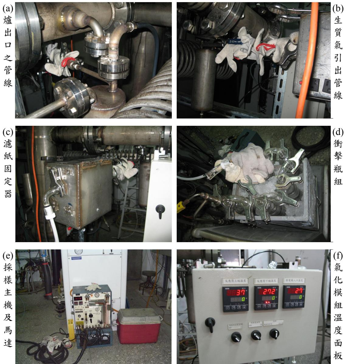
圖 2-10 小型氣化模組尾氣中焦油採樣實況
