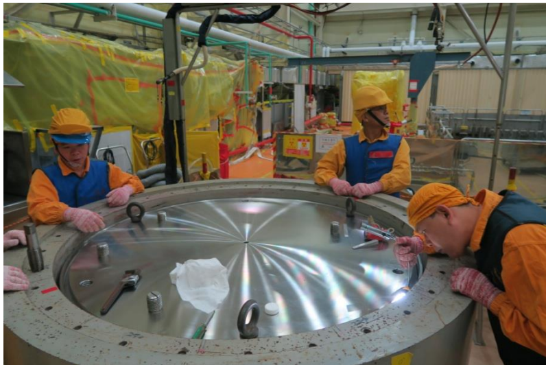
孔蓋銲接非破壞檢測
