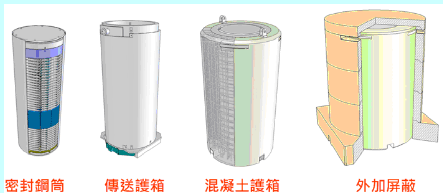
核一廠乾式貯存護箱系統組件
