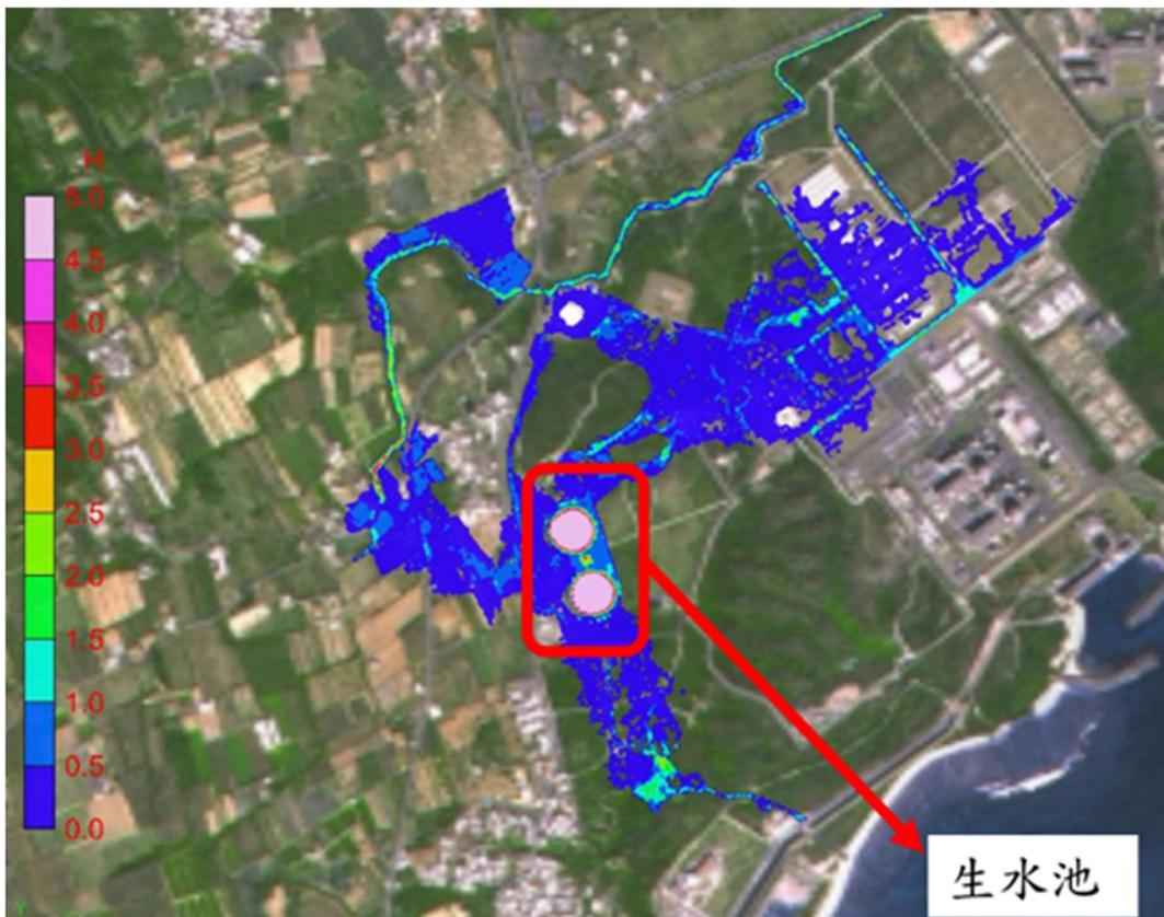
圖 7-4 核三廠生水池潰決洪水最大淹水深度分佈圖(單位：m)
