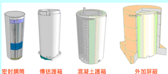
核一廠乾式貯存護箱系統組件
