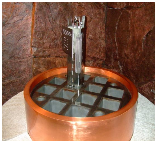
圖 1-6 KBS-3型燃料最終處置罐剖面圖(單位：mm)
