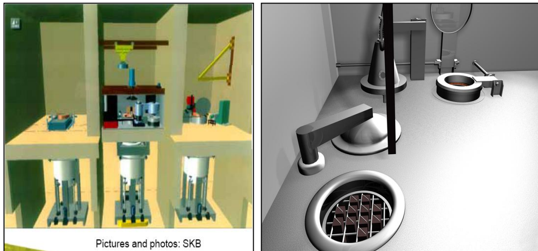
圖 1-5 用過核子燃料束從密封鋼桶轉換至處置用之燃料最終處置罐示意圖
