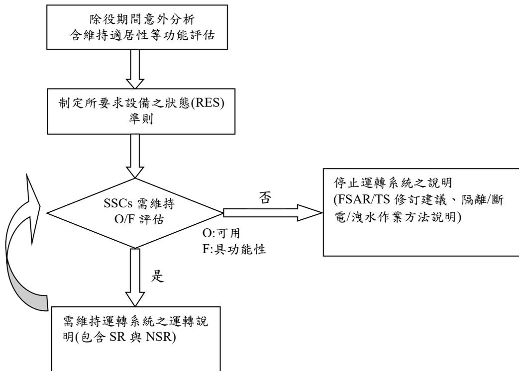
圖 5-2 除役期間系統運轉評估流程
