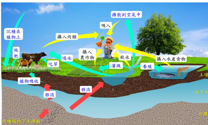
圖 4.1.1-1 達仁場址的生物圈核種傳輸概念模型
