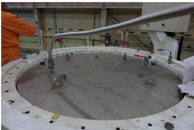
圖 3-55 氦氣測漏作業(2) (TSC-06)
