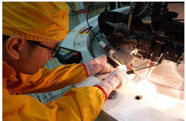
圖 3-58 結構上蓋銲接執行銲機調整(TSC-05)
