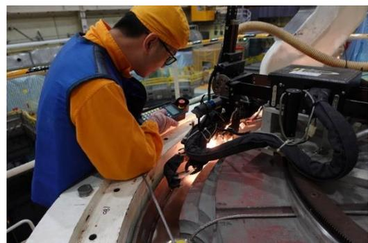
圖 3-38 屏蔽上蓋銲接過程調整作業(TSC-06)
