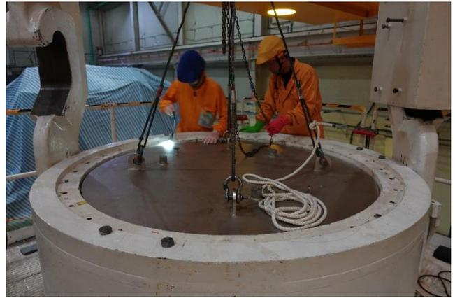
圖 3-54 氦氣測漏作業(1) (TSC-06)
