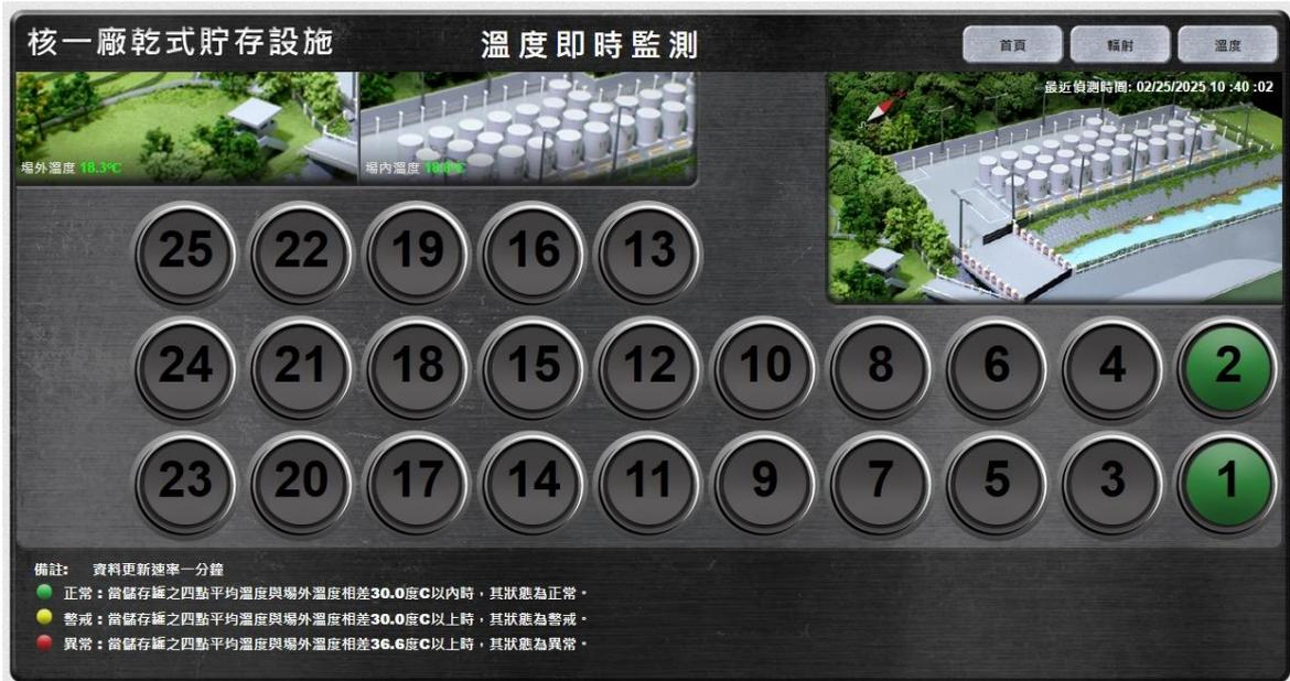
圖 2.4-1 核一廠乾式貯存設施溫度即時監測系統畫面示意圖
