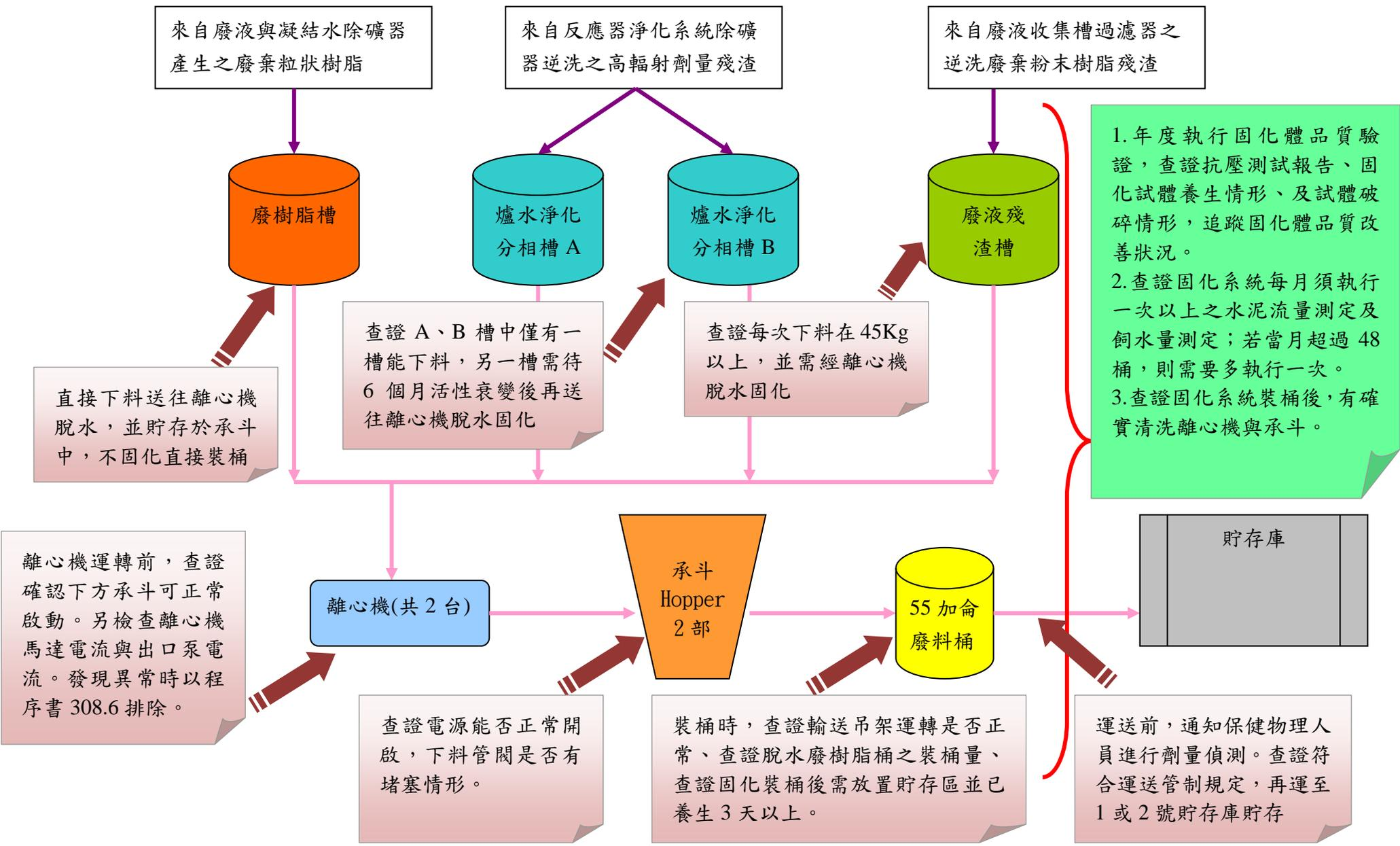
放射性固化處理系統之安全管理重點示意圖
