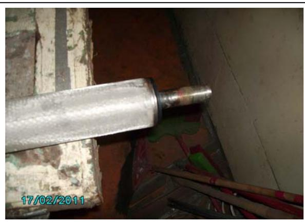
照片六：螺絲螺牙損壞，維修人員以鋸片處理後之濾芯螺牙
