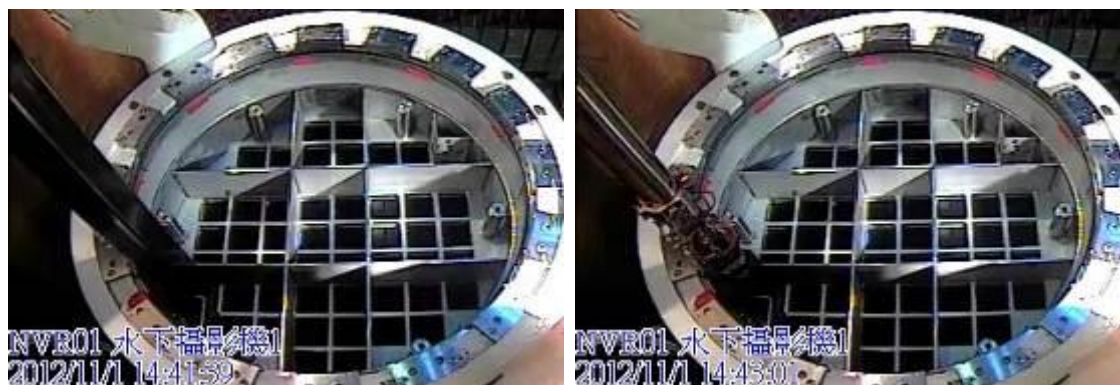
圖 3.3.9 假燃料裝入孔位 DG-1 的連續照片
