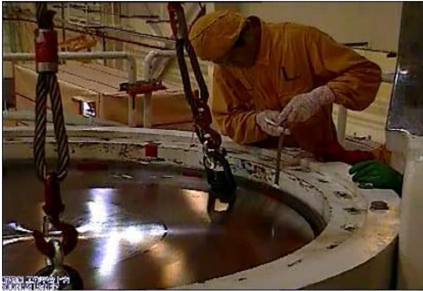
圖 3.3.19 對密封鋼筒外壁進行拭跡偵檢作業
