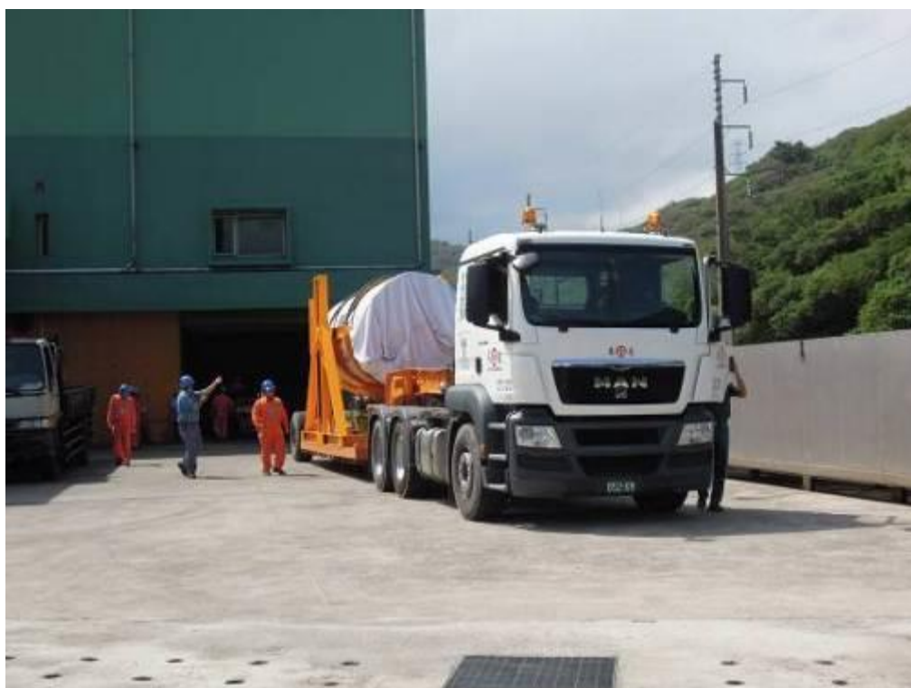
圖 3.2.12 密封鋼筒置於翻轉架上由二貯庫移往反應器廠房
