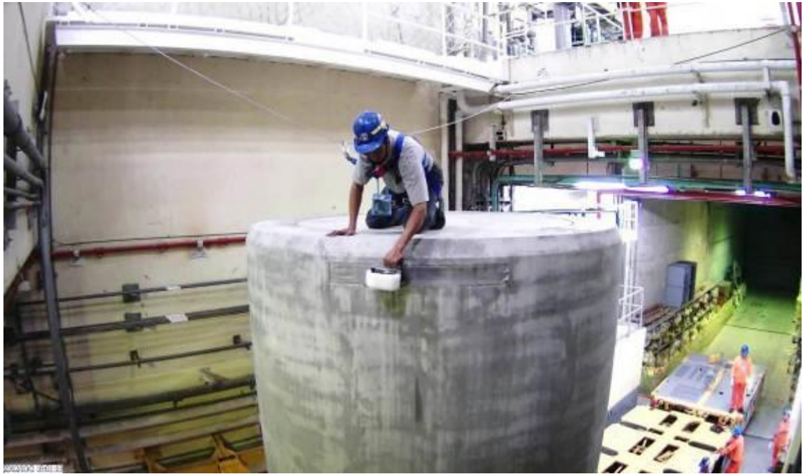
圖 3.2.37 中子劑量率量測
