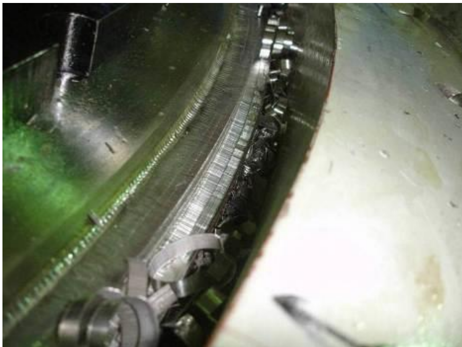
圖 3.1.13 調整刀具進刀位置
