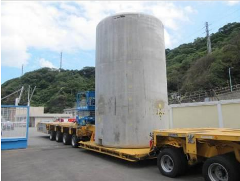
圖 3.2.57 多軸油壓板車駛出主警衛室(第一階段運送驗證)
