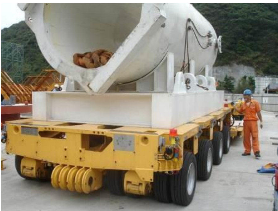
圖 3.2.2 以多軸油壓板車搬運水平狀態的傳送護箱
