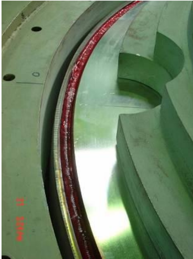
圖 3.1.9 結構上蓋液滲檢測-滲透
