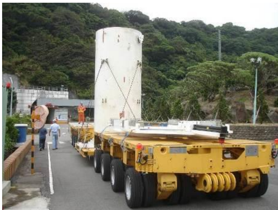
圖 3.2.4 傳送護箱運送往 1 號機反應器廠房
