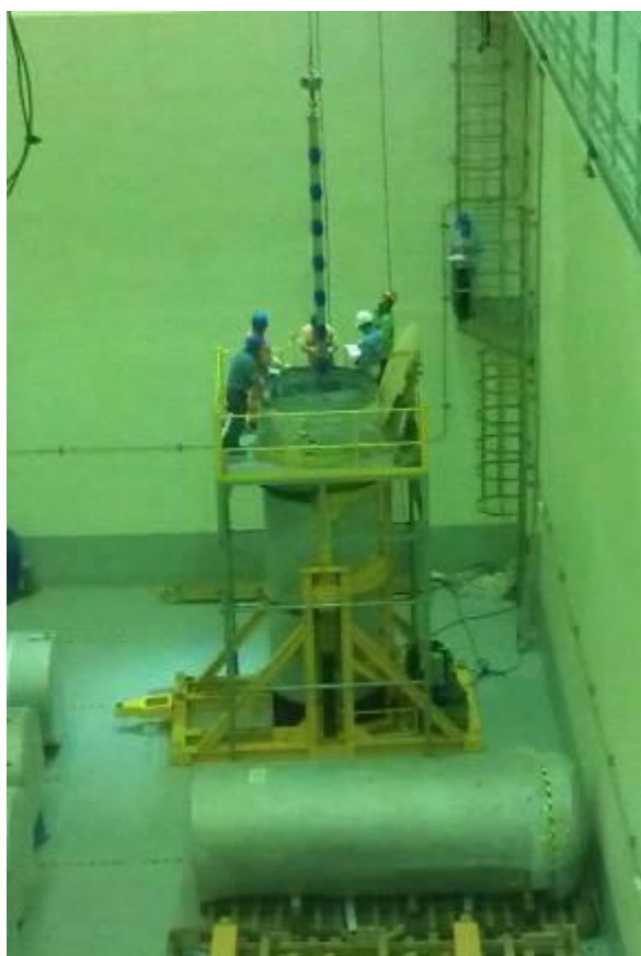
圖 3.2.10 密封鋼筒燃料方管阻力測試(1)
