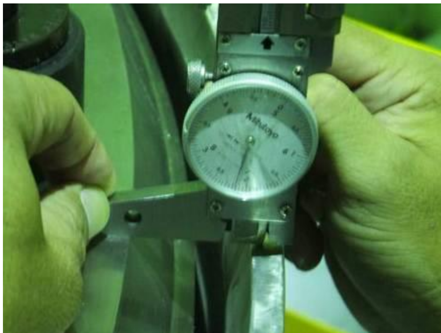
圖 3.2.9 密封鋼筒組件尺寸檢查量測結構上蓋與筒壁上緣之高低差
