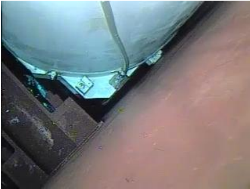
圖 3.3.15 利用水下攝影機觀察傳送護箱底部通過框架
