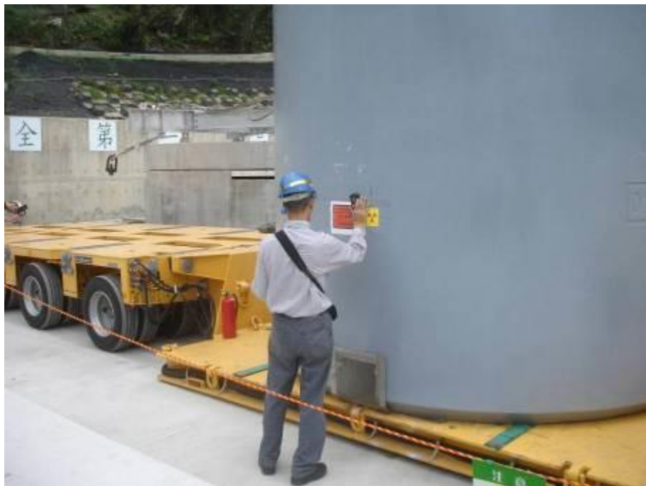
圖 3.2.62 混凝土護箱表面劑量率量測
