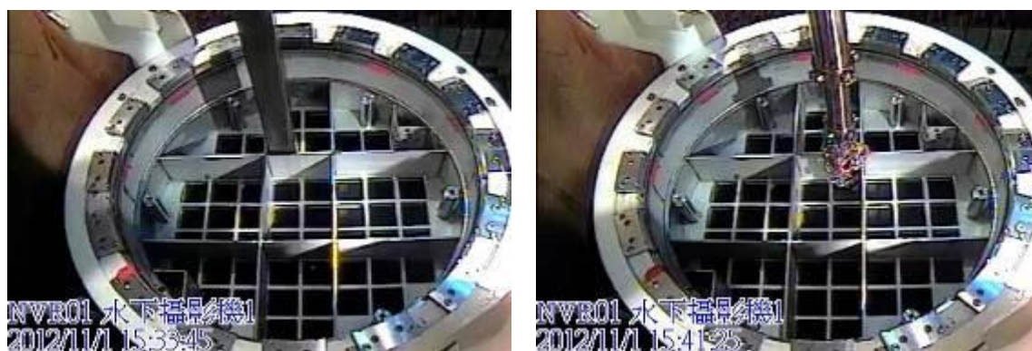
圖 3.3.10 於孔位 DC-4(左)與 DD-5 吊運假燃料之測試照片
