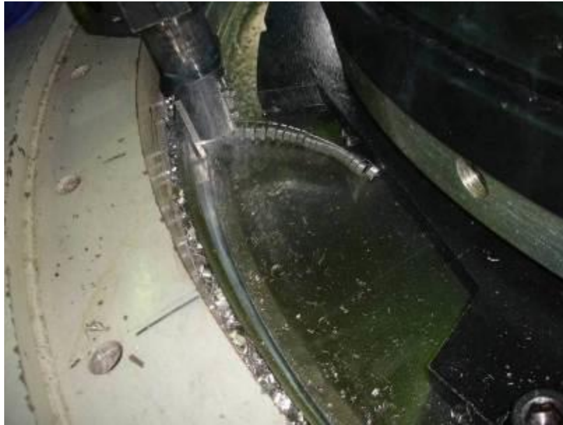
圖 3.1.21 切削中的屏蔽上蓋鐸道
