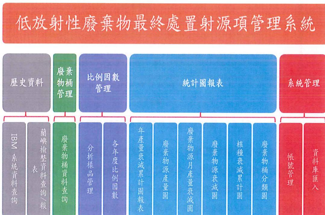
圖一、「低放射性廢棄物最終處置射源項管理系統」功能架構
