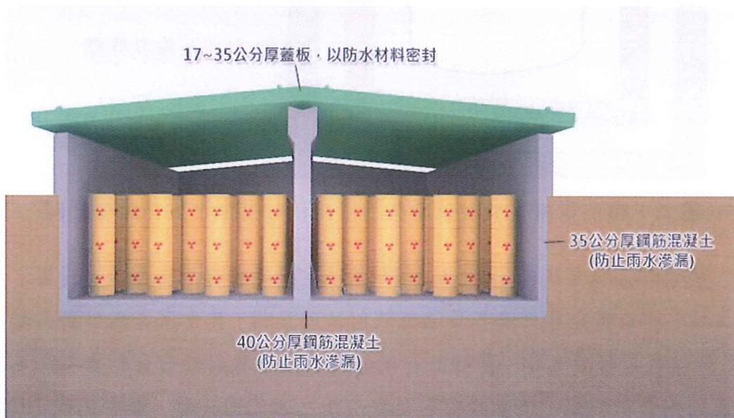
圖四、蘭嶼貯存場貯存溝構造
