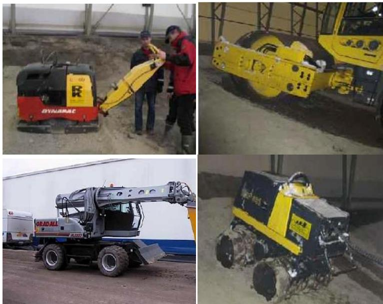
圖 2.1.1-1 因應隧道施工環境之現地滾壓夯實設備
