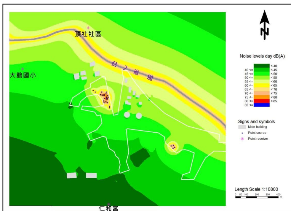
圖 4.1.2-5 廠址復原階段工程及施工運輸作業等噪音線模擬圖
