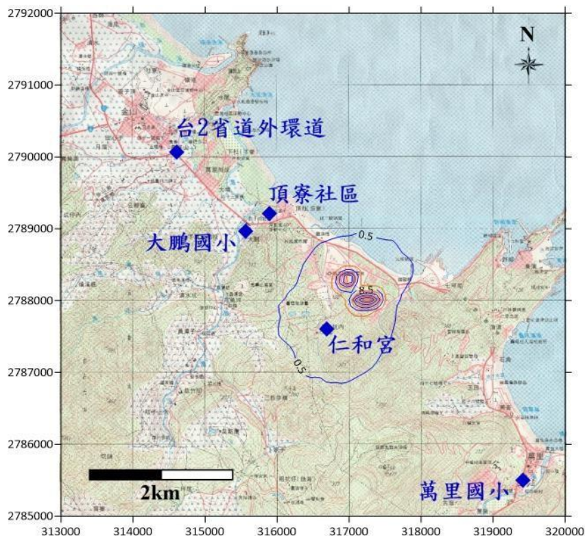
圖 4.1.1-2 除役過渡階段(第 1~2 年) \text{PM}_{10} 日平均增量濃度( \mu\text{g}/\text{m}^3 )
