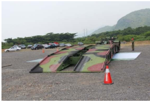
履帶機動橋架設
