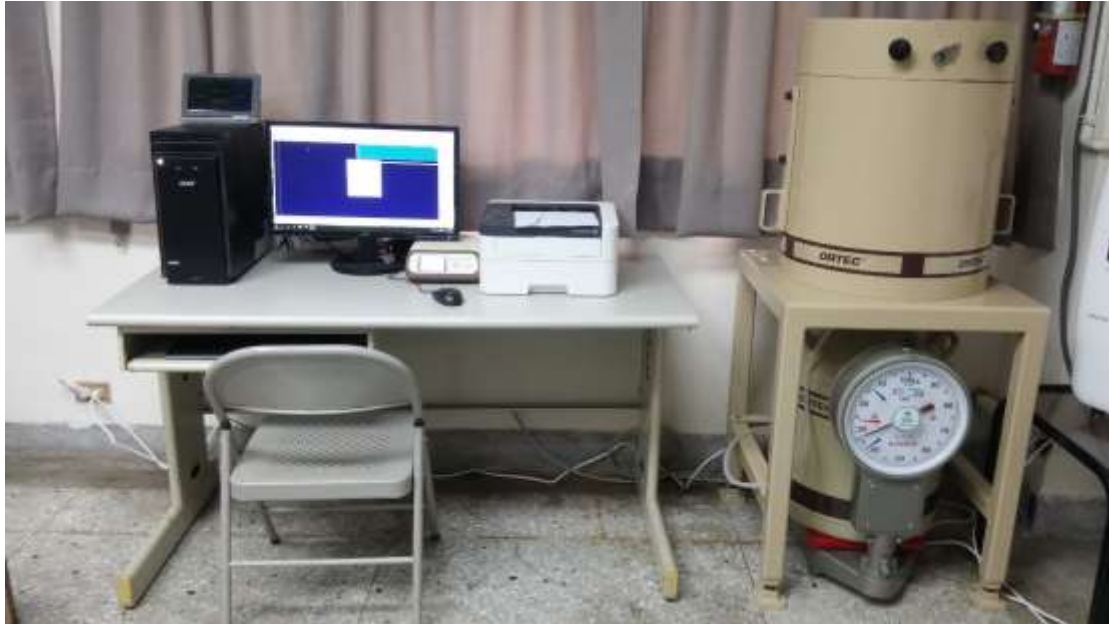
圖 2-1：純鍺偵檢器能譜分析系統安裝完成圖
