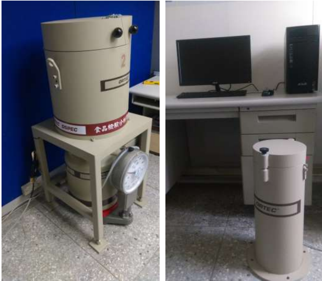
圖 2-2：實驗室第二部純鍺偵檢器能譜分析系統與碘化鈉能譜分析系統之安裝完成圖
