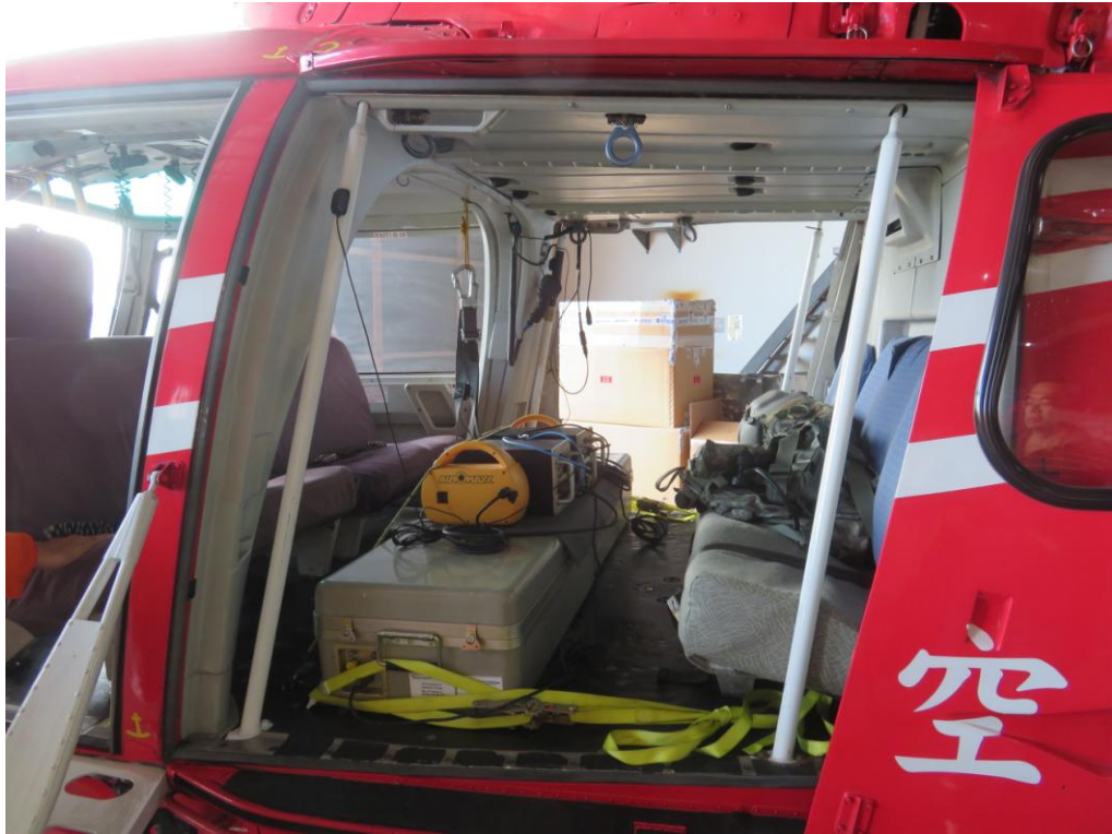
圖 4.3.2 SPARCS 儀器架設建議架設於機艙中央位置。
