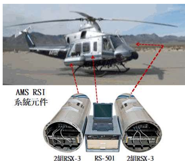
圖 38 DOE Bell 412 直升機(外掛 AMS 加馬輻射偵測儀器)
