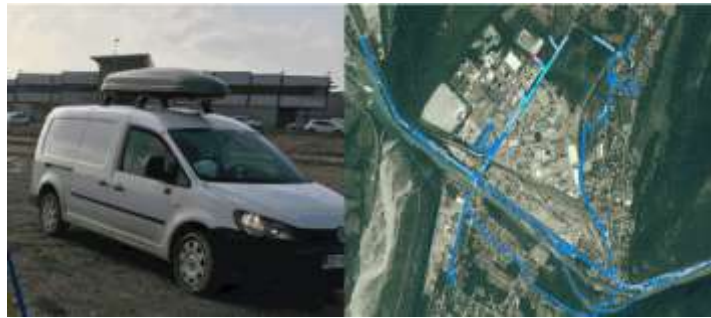
圖 15 AMS 安裝於汽車頂架上執行作業及其偵測結果
