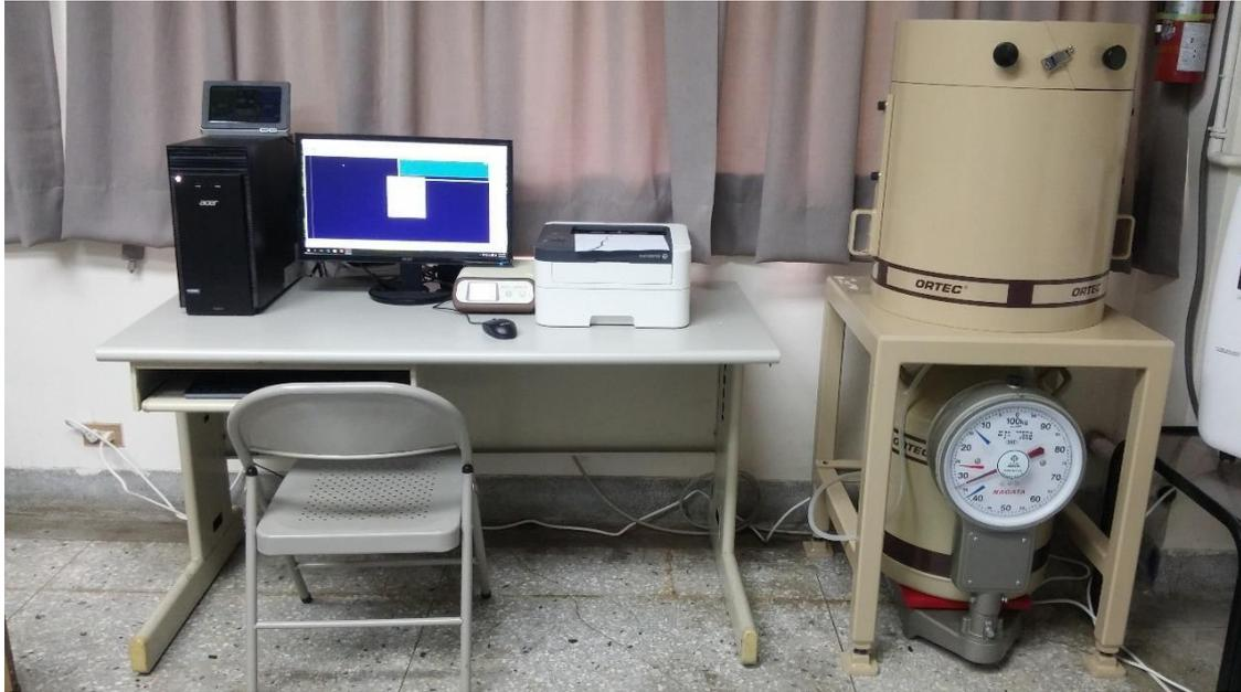
圖 2-7：純鍺偵檢器能譜分析系統安裝完成圖
