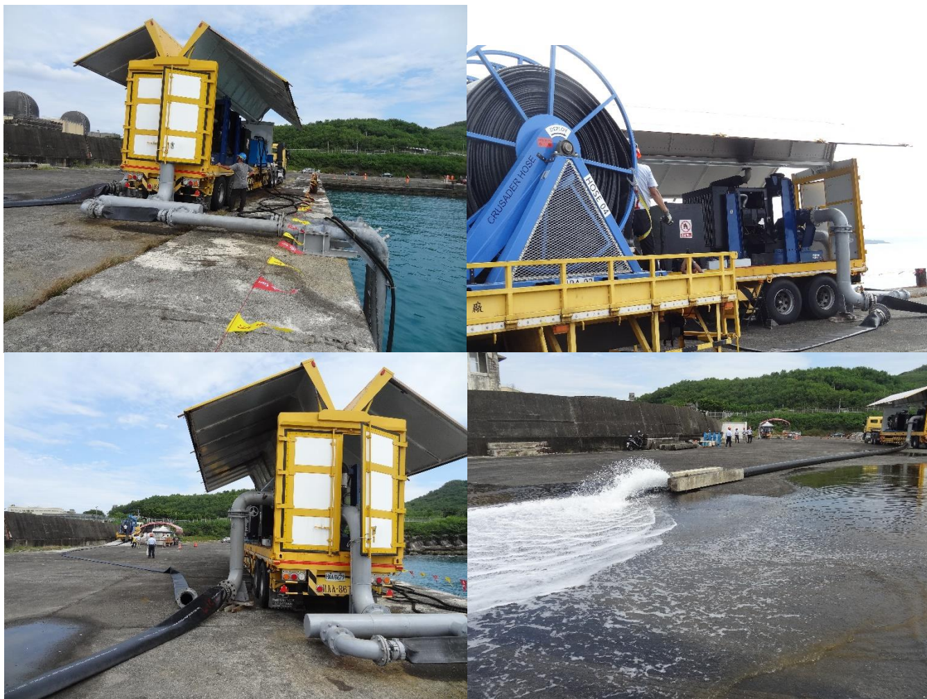
圖 7 9 月 7 日移動式第二熱沉操作演練
