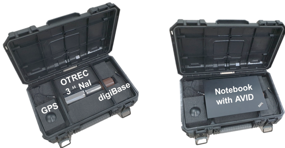
圖 RMC-R-23-3 無人機空中偵測偵檢器箱配置圖
