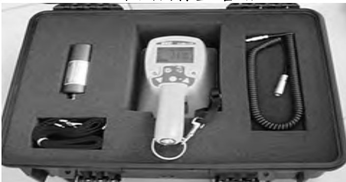
CoMo170表面輻射污染偵測儀
