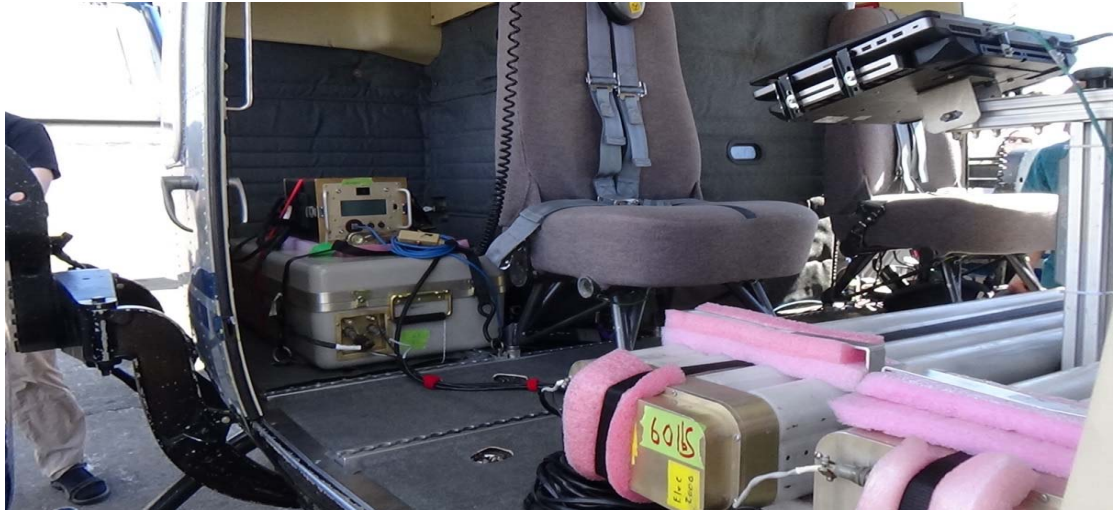
圖45. 直升機Bell 412裝載空中輻射偵測系統(AMS)設備
