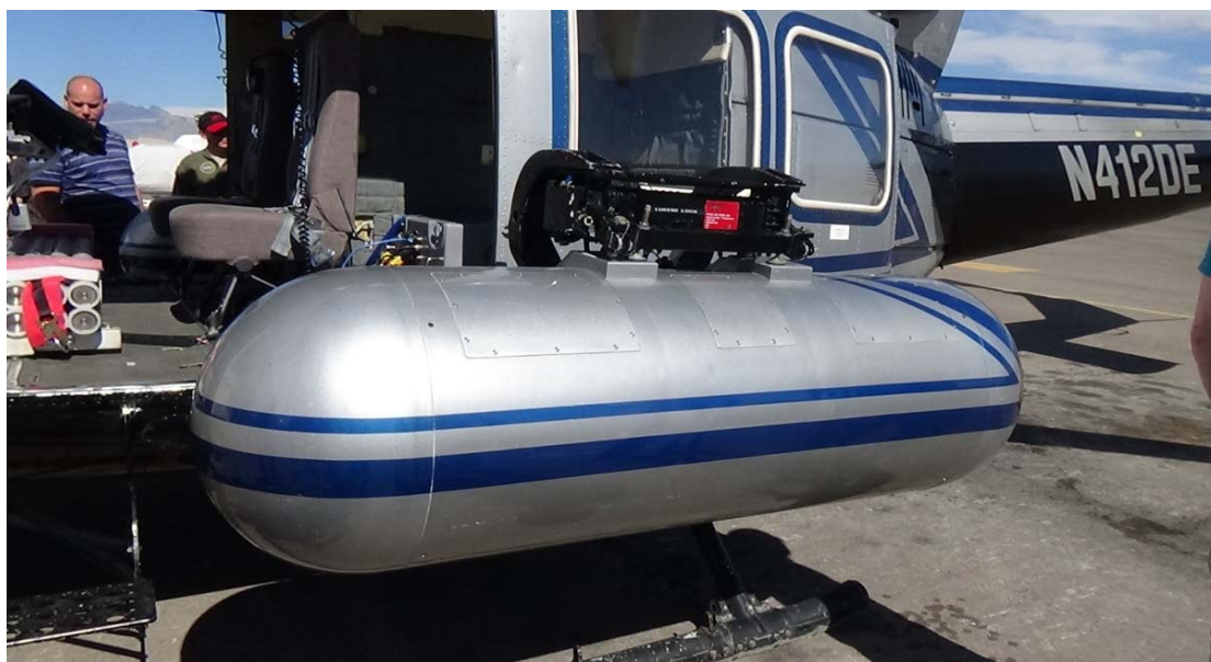
圖48. 直升機Bell 412裝載空中輻射偵測系統(AMS)設備
