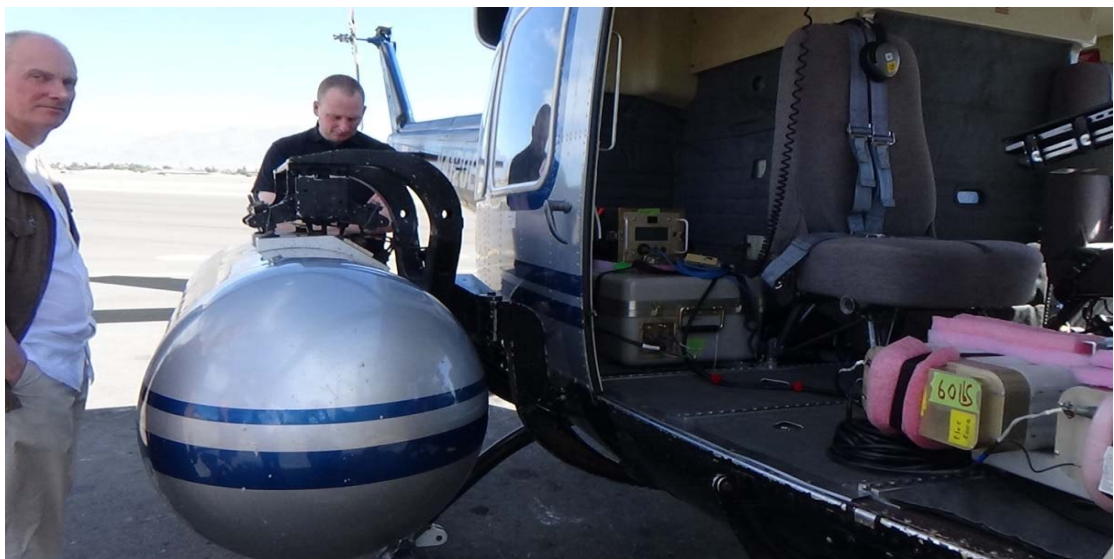
圖47. 直升機Bell 412裝載空中輻射偵測系統(AMS)設備
