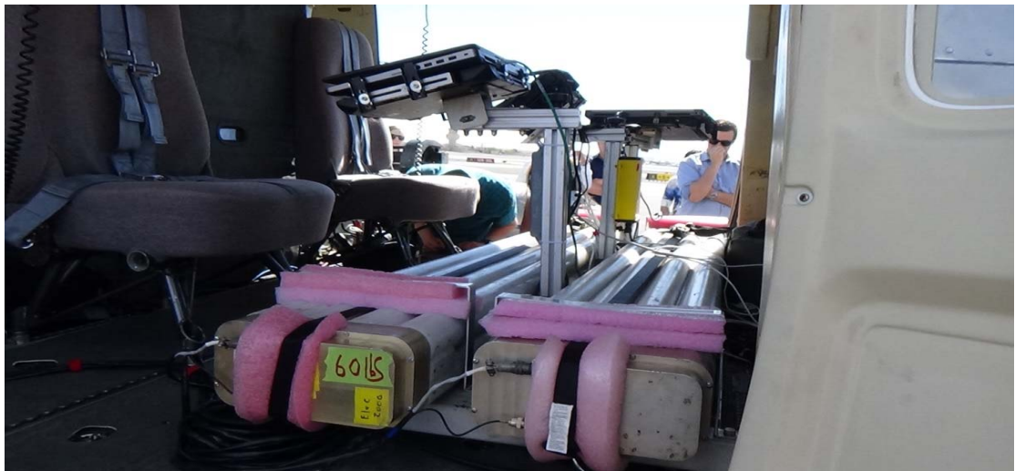
圖46. 直升機Bell 412裝載空中輻射偵測系統(AMS)設備
