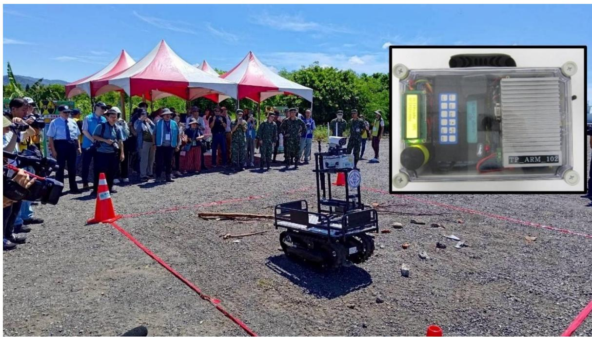
圖 6-4 利用無人車搭載機動式輻射偵測儀執行輻射偵測
