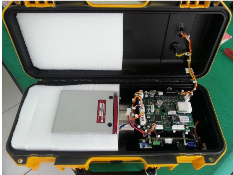
圖 4-5PGIS-2 輻射偵檢設備內部構造圖
