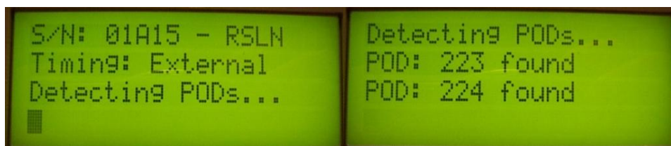
圖 2-13 顯示 ATU 自動去偵測 2 個控制模組訊號之過程
