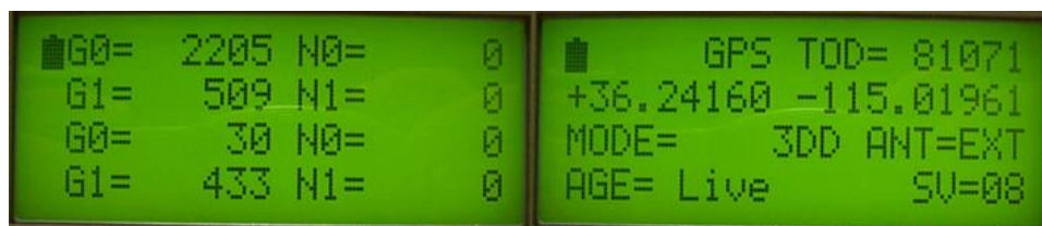
圖 2-14 顯示 4 根碘化鈉偵檢器的計數值和 GPS 的訊號
