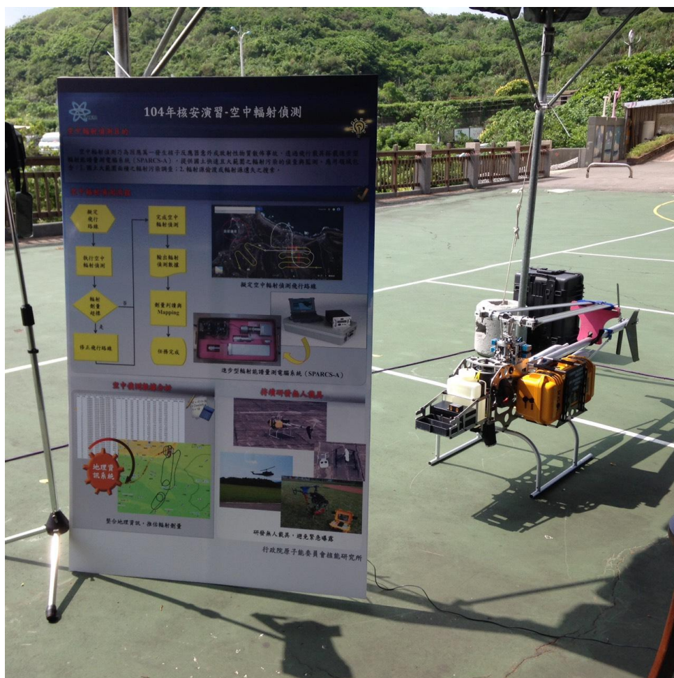
圖 5-14104 年核安第 21 號演習空中輻射偵測站(UAV)
