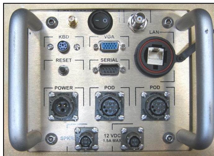
圖 2-9 資料擷取和傳送單元(ATU)的後面板(rear panel)
