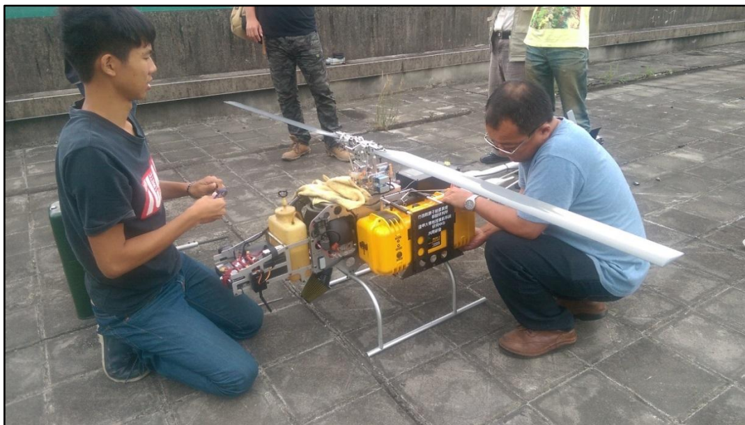
圖 4-6PGIS-2 輻射偵檢設備與無人載具整合研發圖
