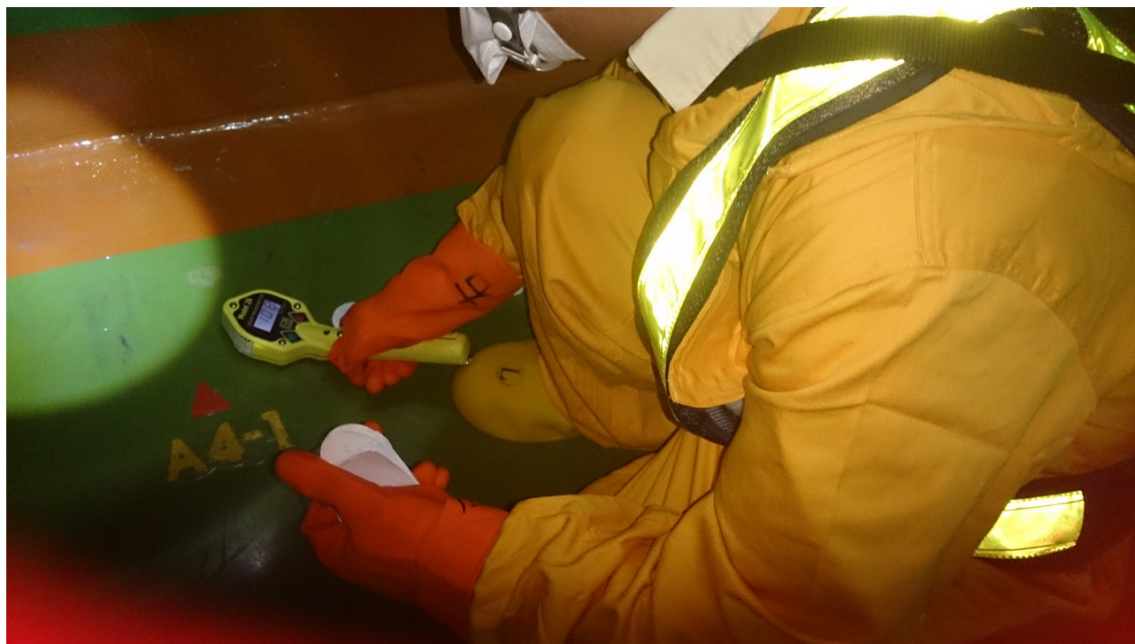
廠房內進行污染量測
