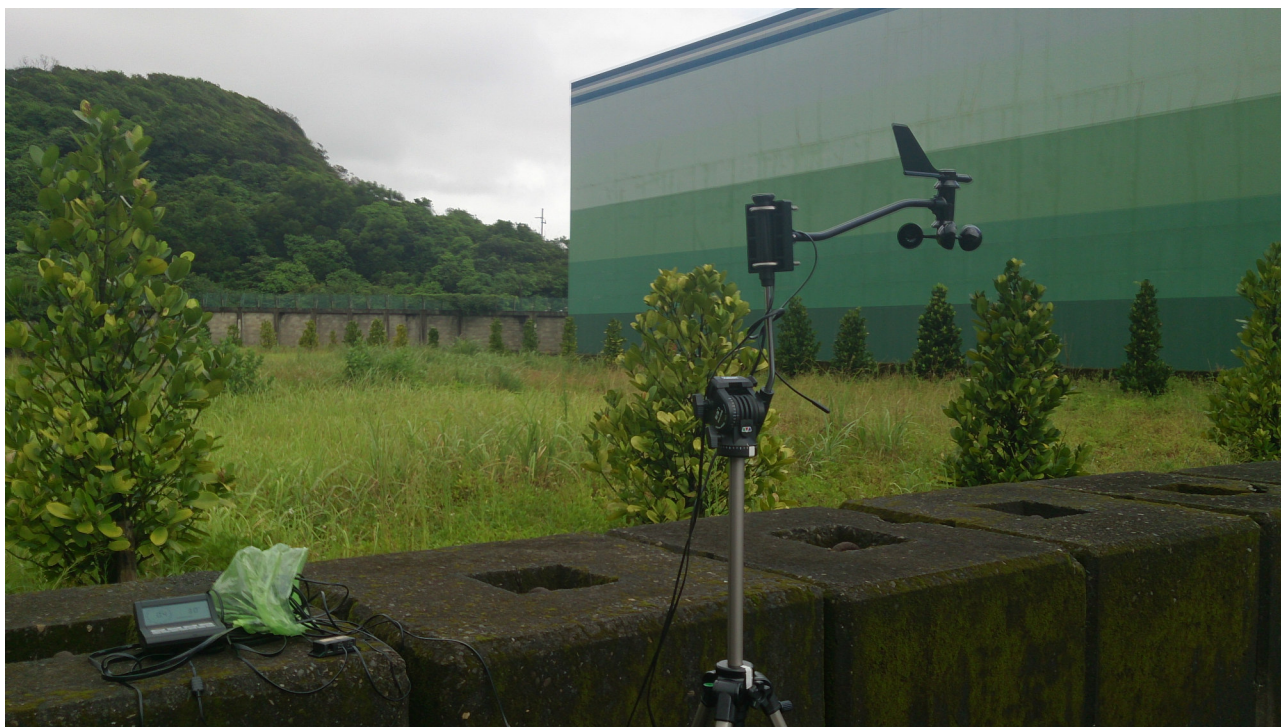
廠界架設風向及風速測定儀
