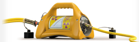
非破壞照相檢測 ( Ir-192 、 Se-75 、 Co-60 )
