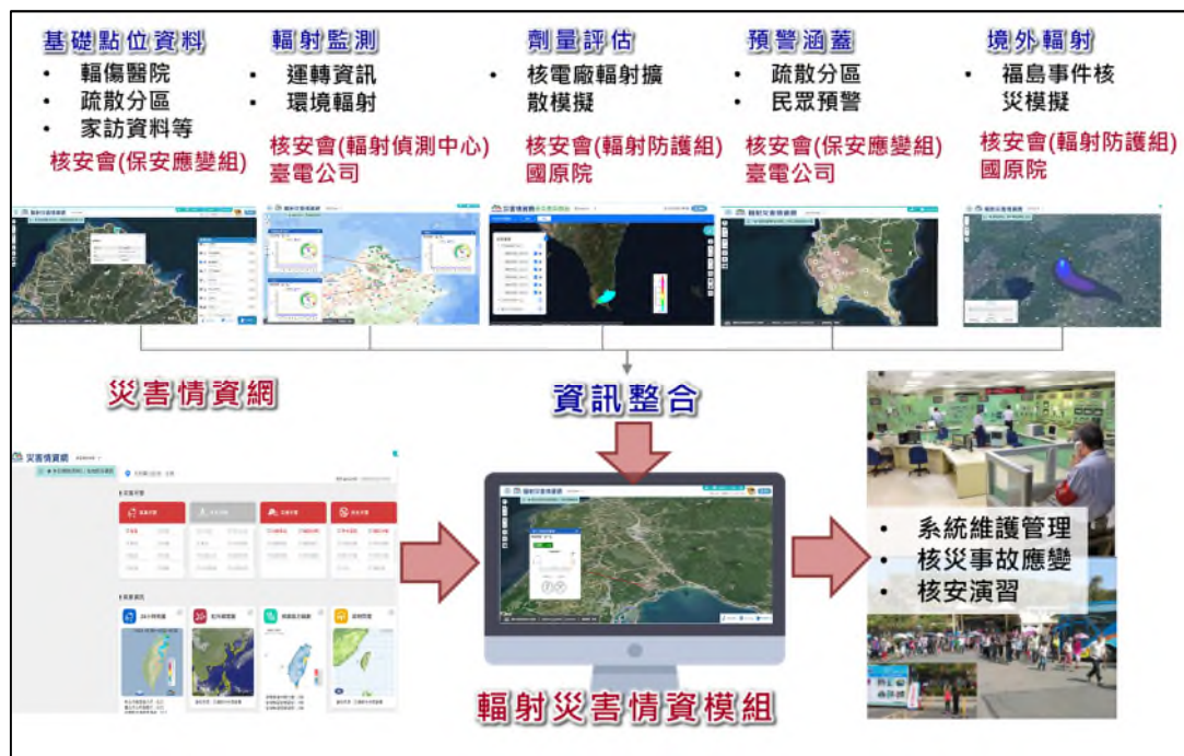
圖 3 輻射災害災情網資訊整合架構圖
