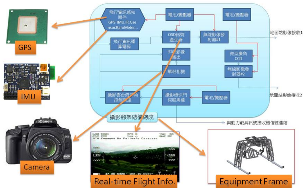
圖 4.6 航空電子/攝影系統架構圖
