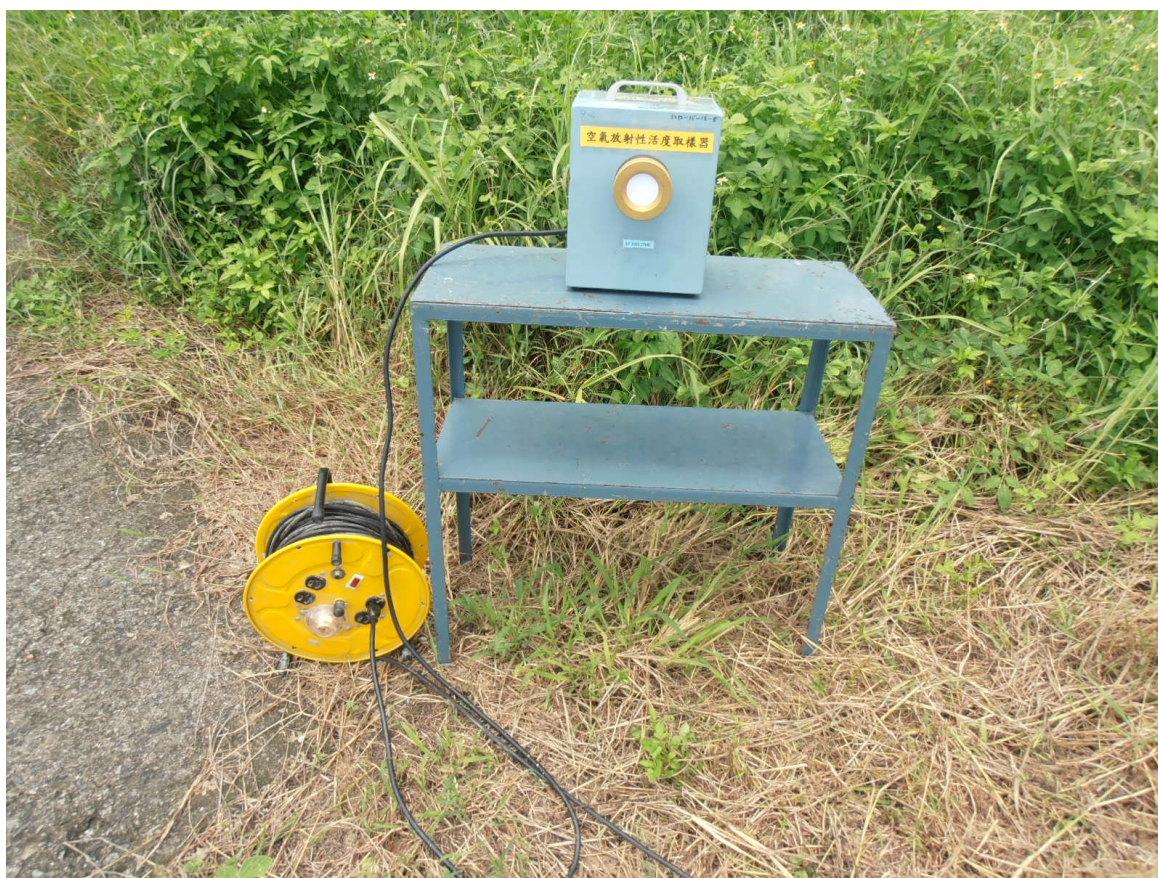
廠界架設空浮取樣器
