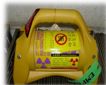
RT非破壞檢測 (Ir-192、Se-75、Co-60)
