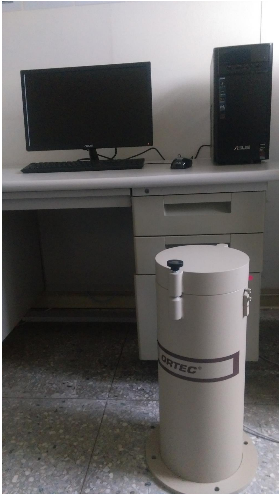
圖 2-2：碘化鈉能譜分析系統安裝完成圖
