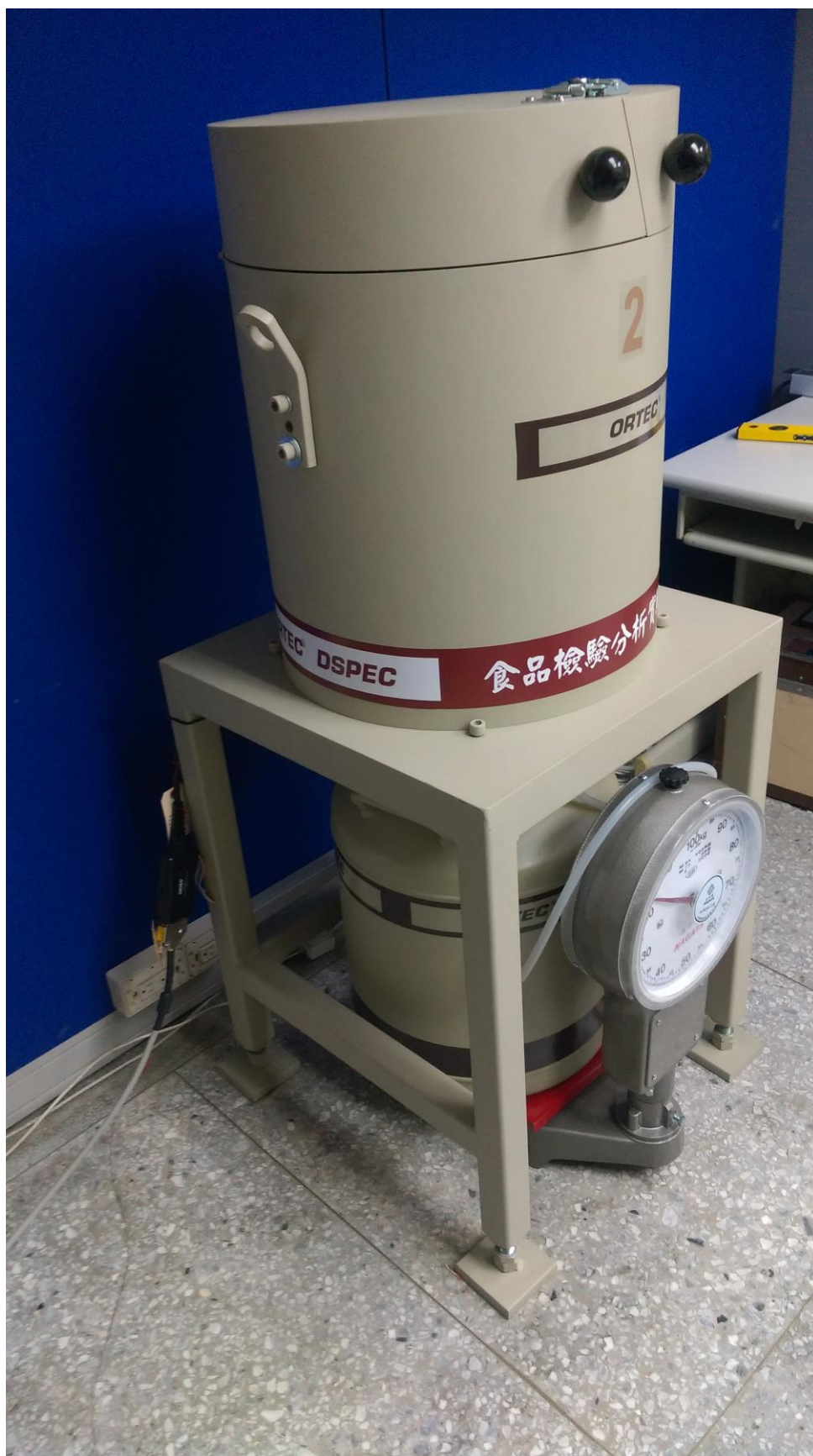
圖 2-1：純鍺偵檢器二號機與能譜分析系統安裝完成圖
